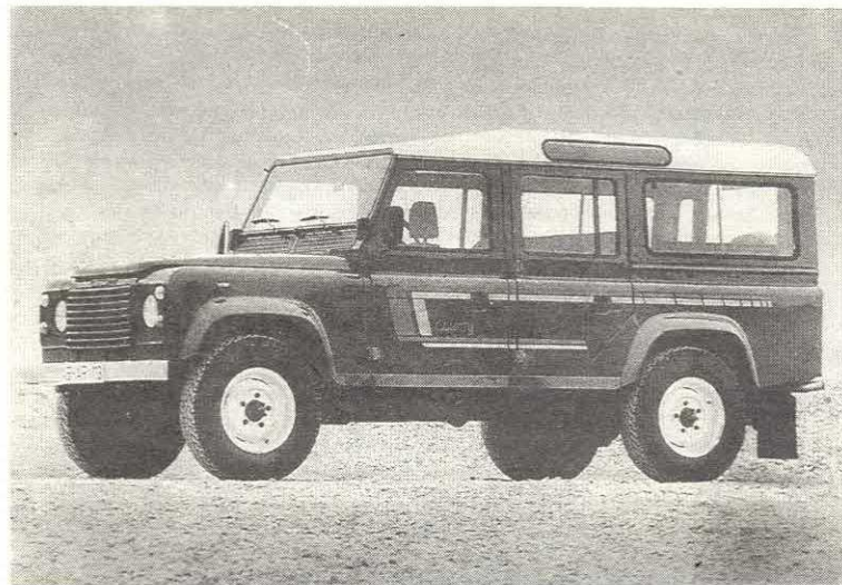
«Ланд-Ровер-110» с пятидверным кузовом на длиннобазном [2794 мм] шасси.
