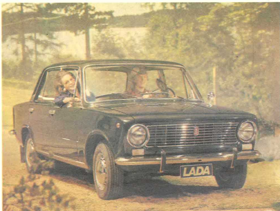
Первая модель завода — ВАЗ-2101, представляющая собой дальнейшее развитие конструкции ФИАТ-124.
